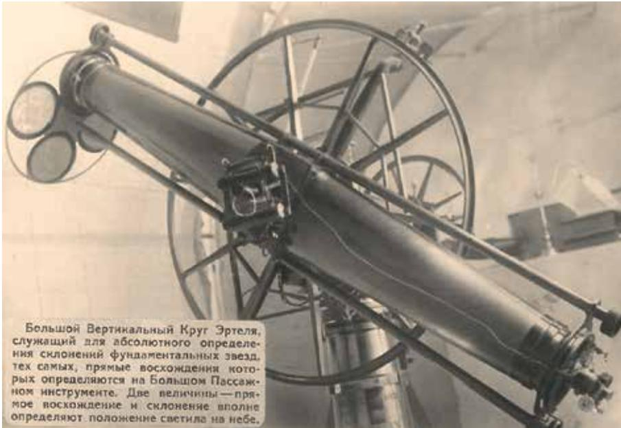
*Большой вертикальный круг Эртеля-Струве для определения склонений звезд
