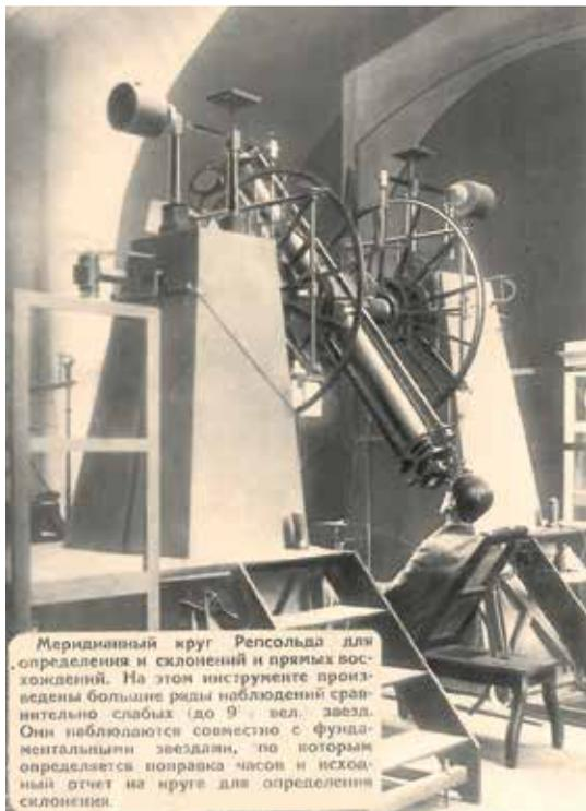
*Меридианный круг Репсольда, установленный в первом вертикале, для определения астрономических постоянных — абберрации и нутации
