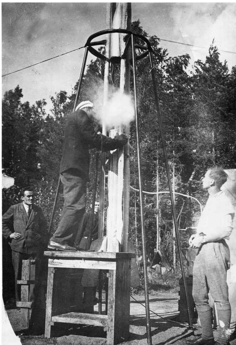
Ил. 4. Фотография ракеты «09» перед стартом. Заливка кислорода в бак ракеты. Стоят (слева направо): Королев С.П., Ефремов Н.И., Победоносцев Ю.А. 1933. АРАН. Р.IV. Оп.14. Д.83.
